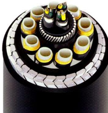
Figura 9 - Seção de um umbilical eletro-hidráulico. (PETROBRAS, 2016)
