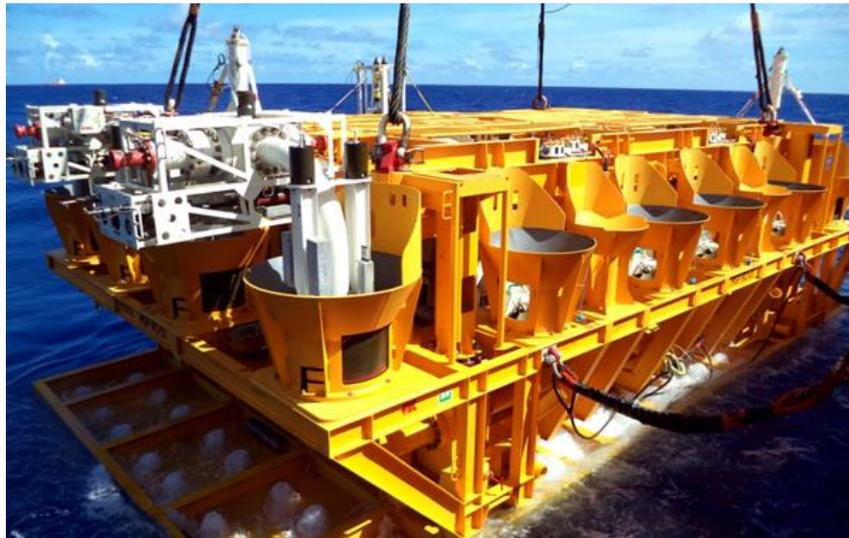
Figura 5 - *Manifold* de produção empregado no Campo de Roncador. (PETROBRAS, 2016)
