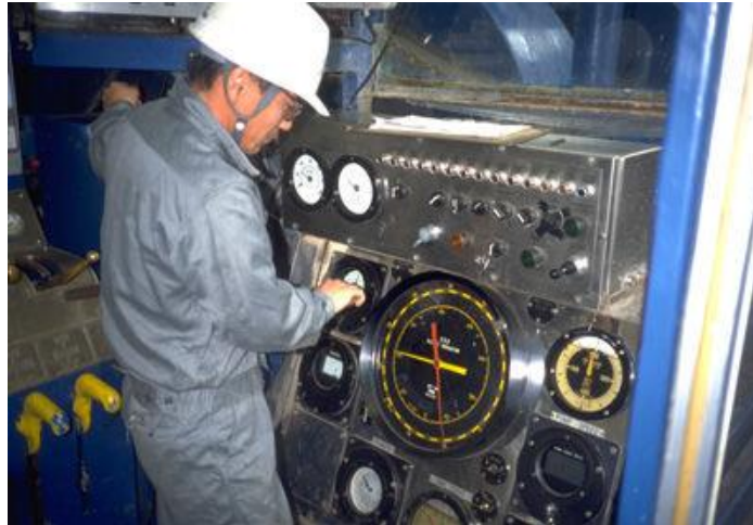
Figura 3.4: Painel do sondador. (Fonte http://www.tecnicodepetroleo.ufpr.br/apostilas/engenheiro_do_petroleo/perfuracoes.pdf )
