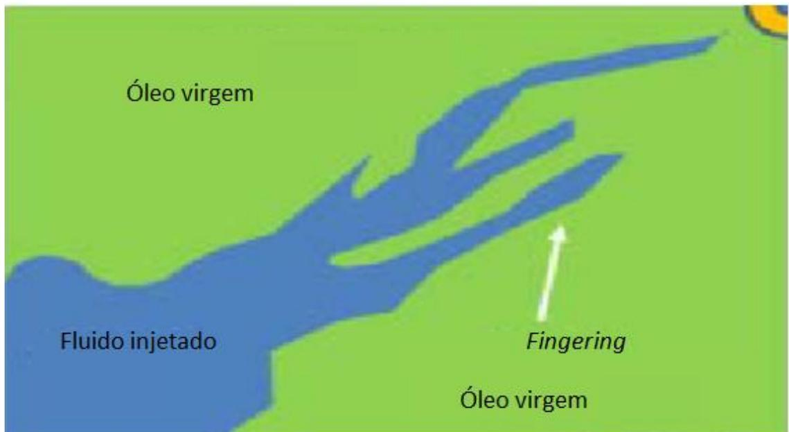
Figura 4 – Formação de *fingering* do fluido deslocante no óleo.
