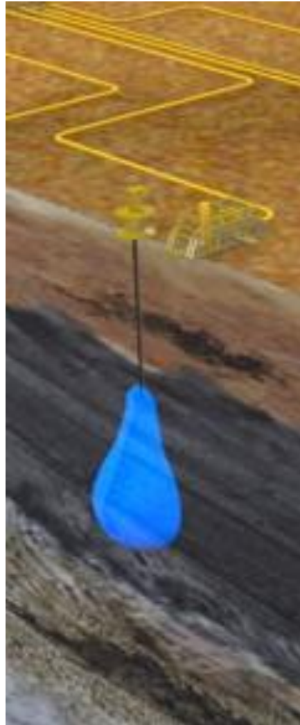
Figura 64. Desenvolvimento da caverna pelo uso de bombeio submerso sem uso contínuo de sonda de apoio
