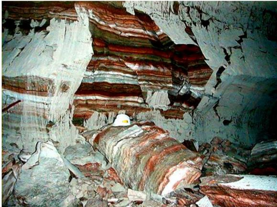
Figura 94. Desabamentos de cantos dos pilares de painéis de uma mina de potássio. Fenômeno usual em minas convencionais de sal
