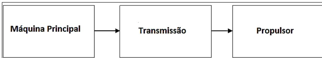
**Figura 3.1:** Principais componentes do sistema de propulsão.
