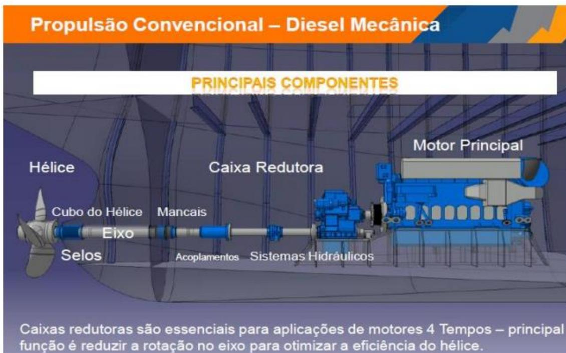
**Figura 3.4:** Propulsão diesel mecânica.
