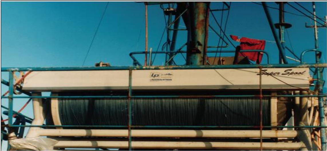
**Figura 4.5:** Tambor com guincho hidráulico utilizado no lançamento e recolhimento do espinhel.
