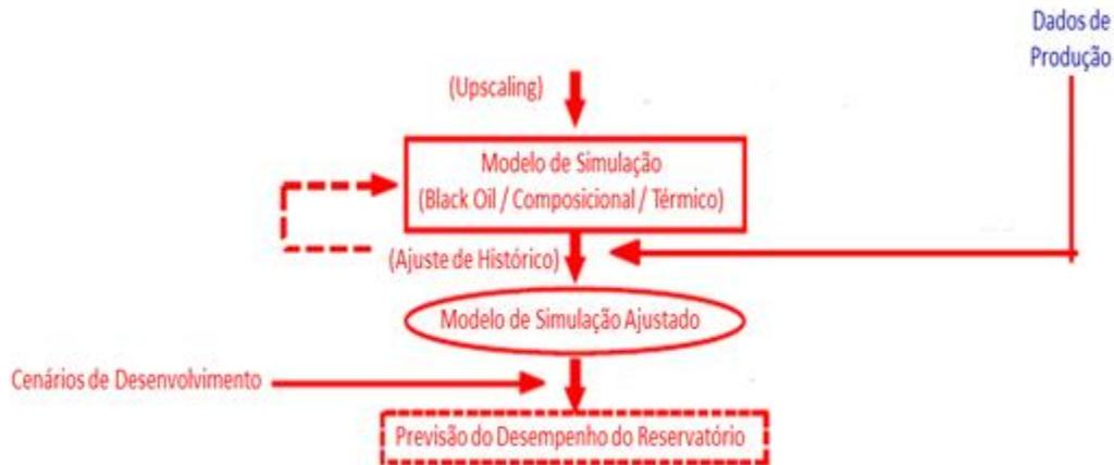
**Figura 2-4: Processo de construção do Modelo Ajustado. Modificado de ALA (2017).**
