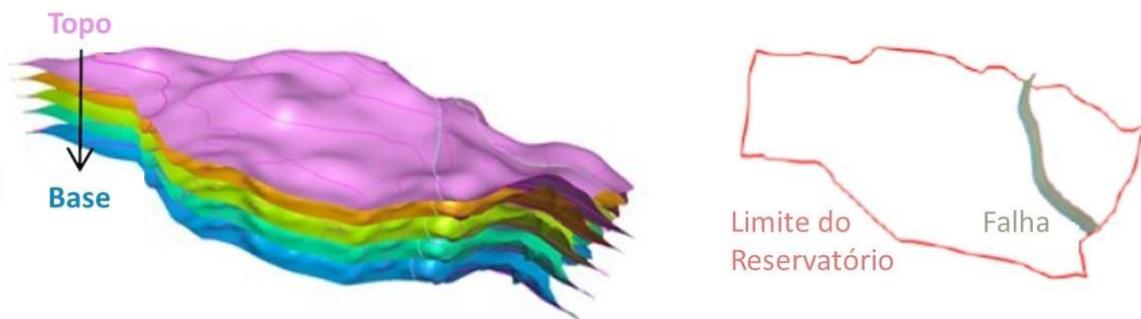
**Figura 3-7: Camadas (esquerda) e falhas (direita) de um modelo sintético baseado no Campo de Namorado, Bacia de Campos, Brasil. Modificado de AVANSI e SCHIOZER (2015).**
