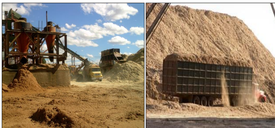
Figura 2 – Exemplo de disposição do bagaço da cana numa usina
