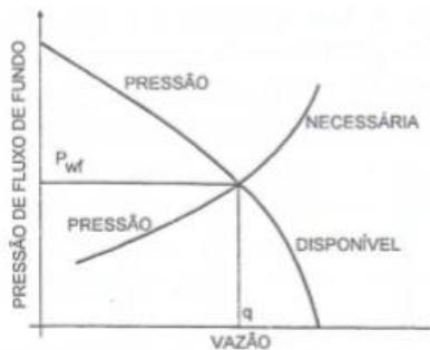
**Figura 3-4: Determinação do ponto de operação**
